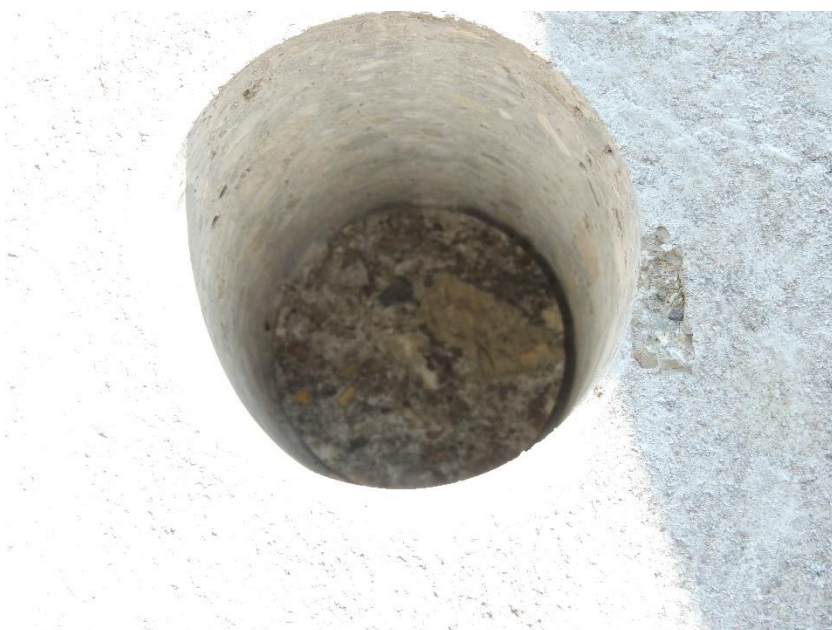
Pohled do otvoru po odběru vzorku betonu z klenby K01 u O01
