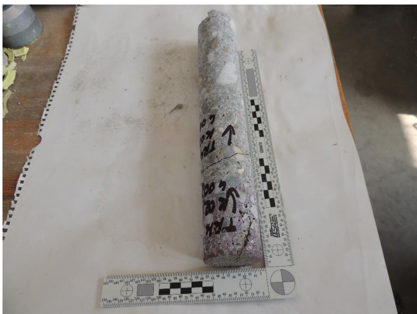
Fotodokumentace provedeného vívrtu přes trhlinu v klenbě K02
